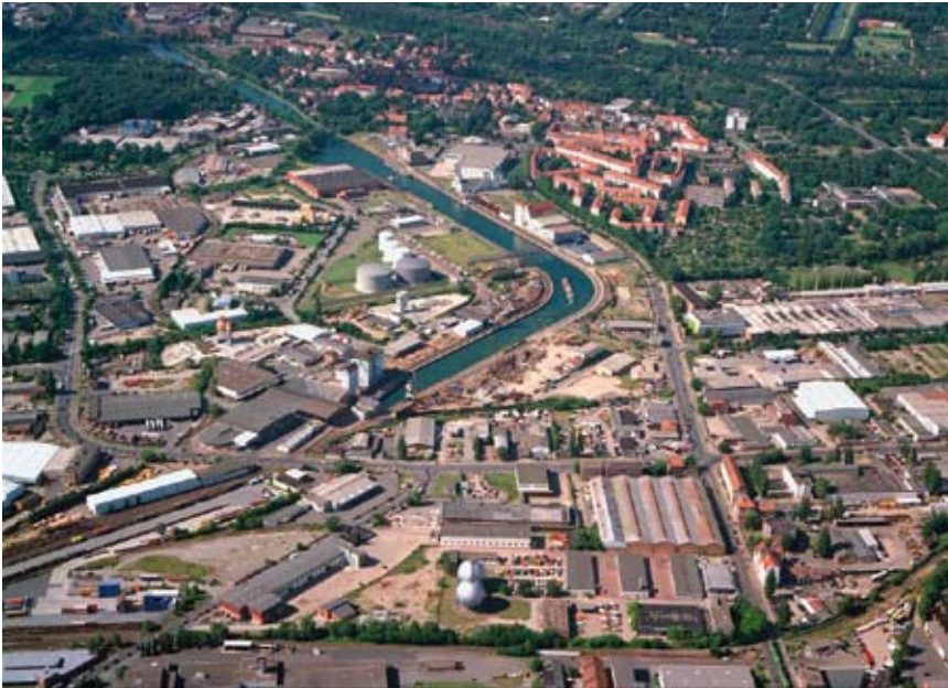
Der Lindener Hafen aus der Vogelperspektive. Im Vordergrund links gut zu erkennen: der Gleisanschluss. An den Binnenhäfen verknüpfen sich die drei Verkehrsträger Wasserstraße, Schiene und Straße. (Bild: Hafen Hannover)
